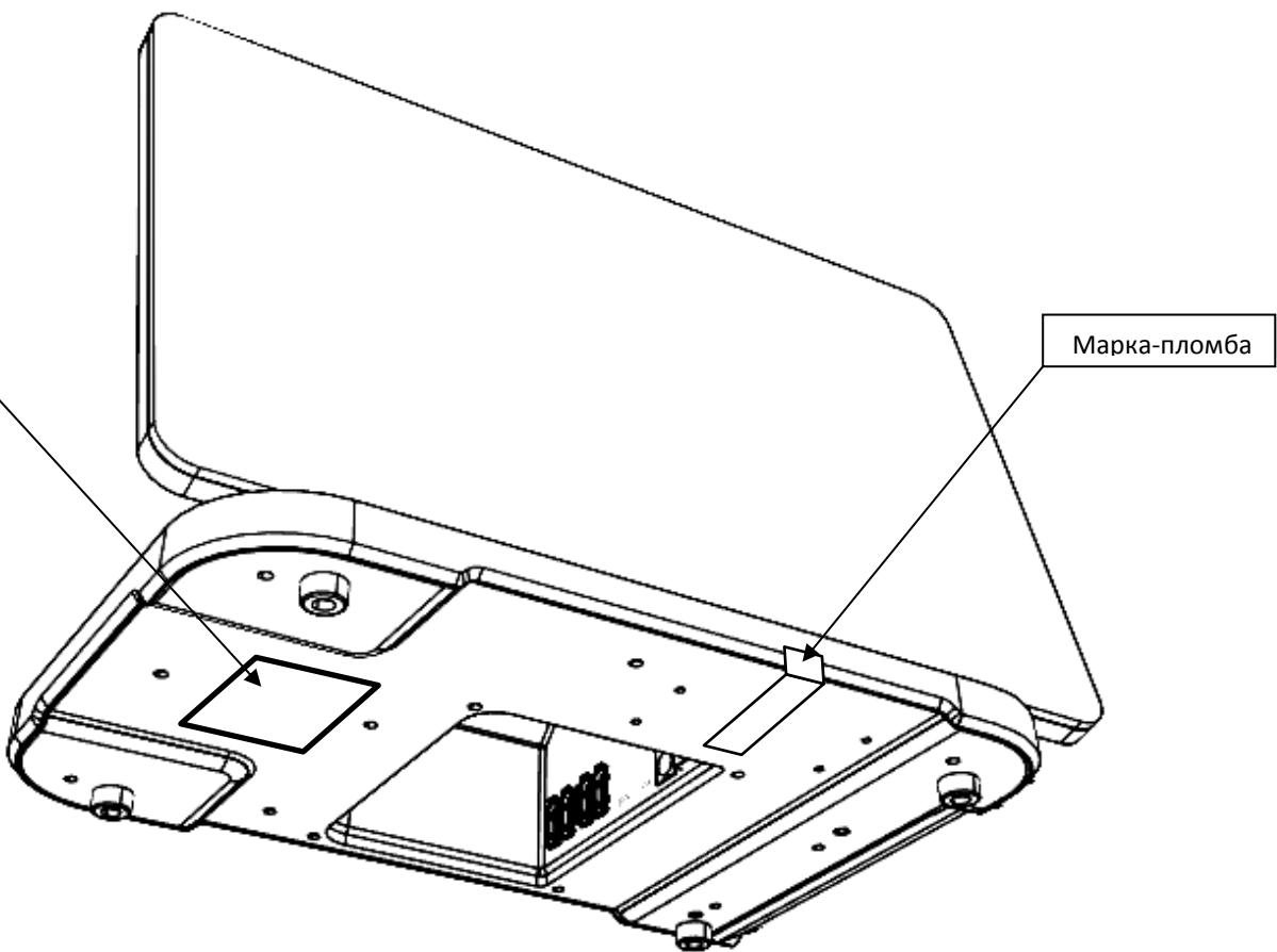
Одна марка-пломба наклеивается на кожух, закрывающий блок управления и устройства печати кассовых чеков так, чтобы было невозможно получить доступ к внутренней части ККТ без разрушения марки-пломбы. Шильдик наклеивается на дно корпуса ККТ.
