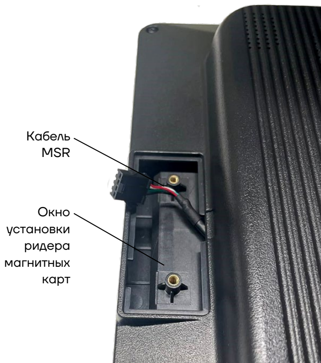
Рисунок 7. Проложенный кабель MSR в окне для установки ридера магнитных карт
